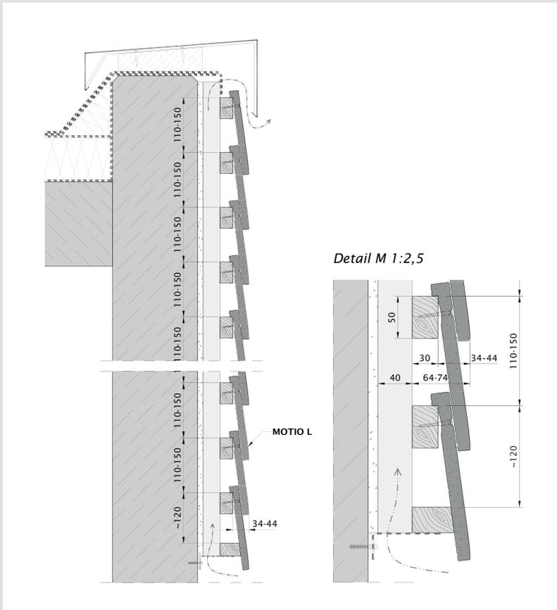
**HINWEIS:** Die dargestellte Zeichnung ist nur ein Konstruktionsbeispiel. Blechführungen werden bauseits nach Vorgaben FVHF-Leitlinie angepasst und durchgeführt. Die Verankerung in der Wand muss zwingend durch einen Statiker berechnet und nachgewiesen werden. Dübel-Auszugsversuche sind am Objekt vom Fachpersonal vorzunehmen, um die Tragfähigkeit nachweisen zu können.
