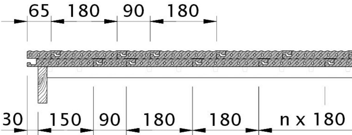
Zeichnung PROFIL Ortgang links mit Ortgangblech und Doppelwulst ODL
